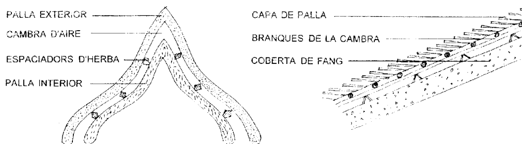
Fig. 8.13 Cubiertas dobles: en el pueblo Masa (Camerún) y en Orisa (India)
