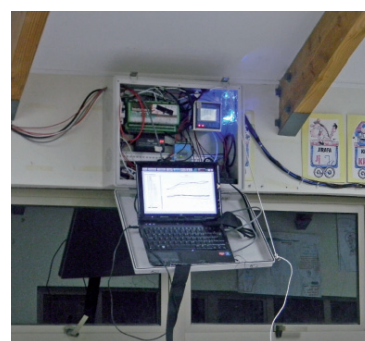
Figura 20. Sistema informático de captura y transmisión de datos de forma remota. Sala 4, escuela Rucamanke. Reigolil, Región de la Araucanía.
