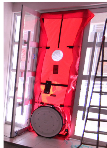
Figura 2.71. Figura 2. 1: Imagen de ensayo de presurización en Edificio Secretaría Regional Ministerial de Obras Públicas Atacama, Copiapó
