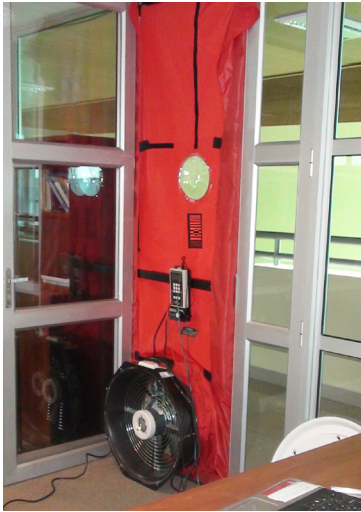
Figura 11. Mediciones de permeabilidad al aire de la envolvente. Edificio Policía de Investigaciones de Puerto Montt.
