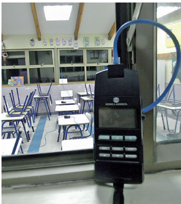
Figura 18. Medición de variables ambientales lumínicas, sala 4 Escuela Rucamanke. Reigolil, Región de la Araucanía.
