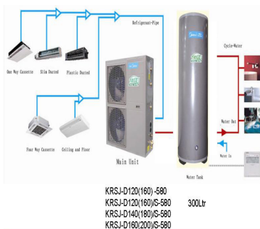
Figura 7.42. Esquema Bomba de Calor VRV multisplit.
