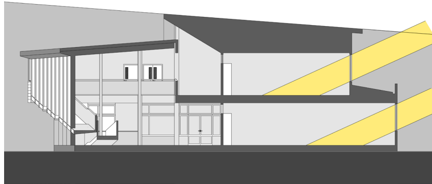
Figura 3.3. Captación solar directa en Escuela Gabriela Mistral, Aysén (zona 8 SE)
