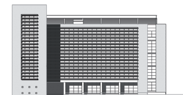
Fachada nor-oriental: Losetas de hormigón como aleros
