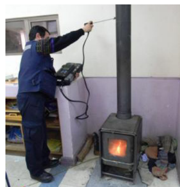
Figura 21. Mediciones de parámetros de combustión en estufas a leña. Escuela Rucamanke Reigolil, Región de la Araucanía.
