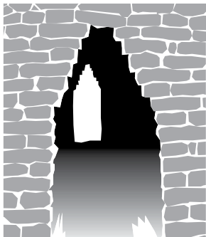
2600 a. C.: Harappa y Mohenjo-Daro, valle del Indo, Pakistán. Ladrillos cocidos y falsos arcos.
